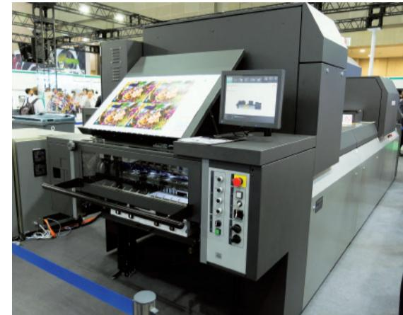
最新機種「Jet Press 750S」は、プリンタヘッドが進化し、オフセット印刷を凌駕する画質をさらにレベルアップさせながら、新乾燥機構との相乗効果で生産性も大幅に向上し、毎時3,600枚の高速出力を実現
