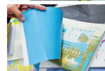
見返しの青い部分はJet Pressの印刷によるもので、左の白い部分はPHOの地色。Jet Pressの色の均一性と、PHOの地合いのよさと平滑性により、一見しただけでは印刷されたものとは分らない
