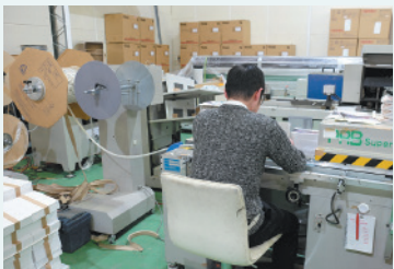
装置メーカーと共に開発、改良を重ねてきたペーパーリング装置。1時間で約1,000冊の製本が可能
