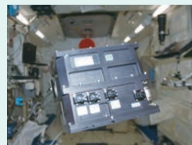
国際宇宙ステーション「きぼう」の与圧実験スペースで使われた氷結晶自由成長実験装置 (写真提供: JAXA/北海道大学)
