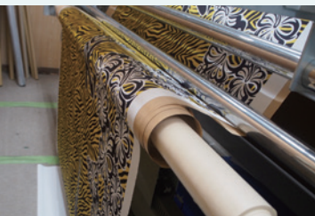
2.5m幅印刷に対応する大判インクジェットプリンター。転写用紙に印刷後、布地に転写する
