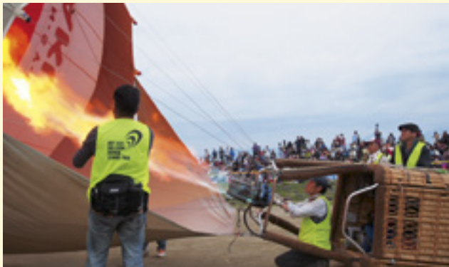
熱気球はバーナーで熱した空気をバルーン内に入れ、「温かい空気は冷たい空気より軽くなる」という原理を応用して空中に浮かびます
