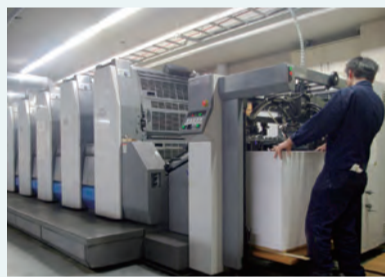
レンチキュラー素材への印刷は難しいため、湿度・温度管理、印刷機のコンディション管理を大切にしています
