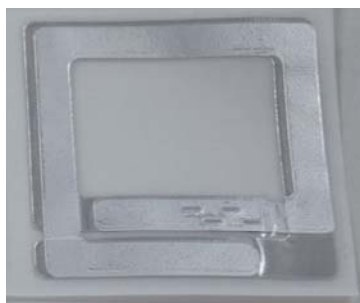
三宅さん開発のダイカット製法のアルミ共振回路タグ。刃型で打ち抜くため回路パターンが高精度で、打ち抜いたアルミ部分はリサイクルもできる
