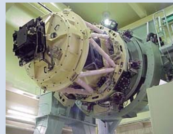
大型光学式赤外線望遠鏡・すばる望遠鏡の撮像装置
