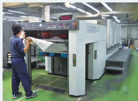
さまざまな改良・開発を重ね、カスタマイズされた恒陽社印刷所のハイブリッドUV印刷機。1時間当たりの生産数を大きく表示し、従業員に高い生産性を意識させている
