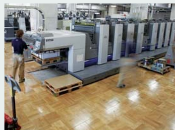
工場の床はナラ材とスポンジを使った、印刷工場では珍しいフローリング。振動を吸収し体の負担を軽減する
