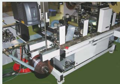
タック印刷のレーザーマーカ―。メーカーのレーザーマーカ―に手を加え、ロール材料への対応や、凸版印刷機との組み合わせを実現する搬送の機構など、ラベル印刷用に独自開発している
