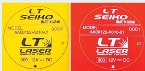
フィルム素材の上に、2層のインキを塗布したシートを使ったラベル。レーザーで削ると、下の層の色が表れ、文字が表現できる
