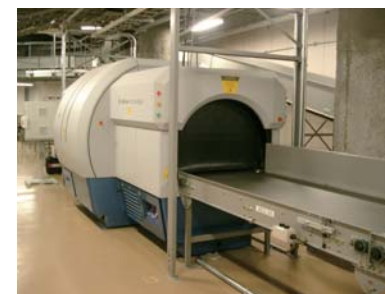
日本で初めて中部国際空港で導入された「インライン方式」の手荷物検査機
